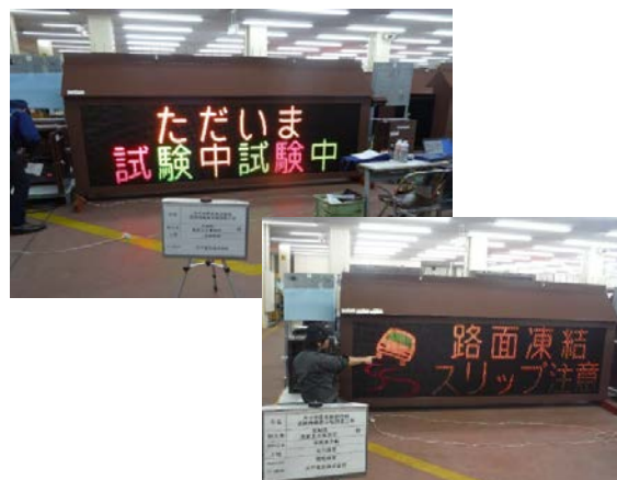
【道路情報表示板工場製作】 工場製作が完了しました 本線と各IC付近に設置予定です
