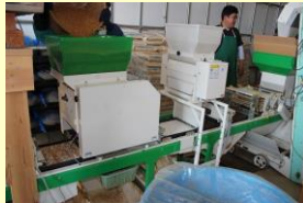
育苗箱への播種・施肥作業 (右から 床土、緩効性肥料、種籾)
