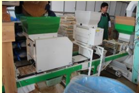
育苗箱播種・施肥作業 (右から 床土、緩効性肥料、種籾)
