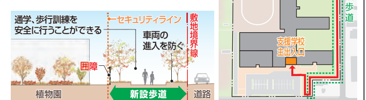
図 2-11：東側歩道部分断面イメージ
