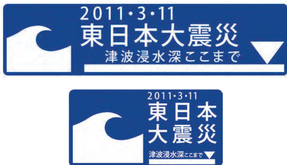
図 5-2 津波浸水表示板（上：300×1,200 サイズ，下：300×600 サイズ）
