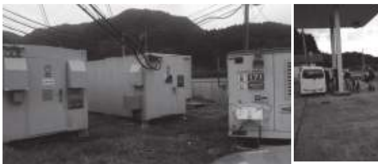
停電エリアでの移動電源車による通信ビルへの電源供給と 近隣スタンドへの支援
