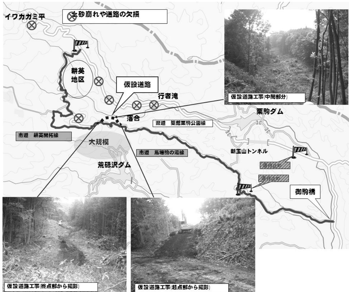
図IX-1 仮設道路工事状況図
