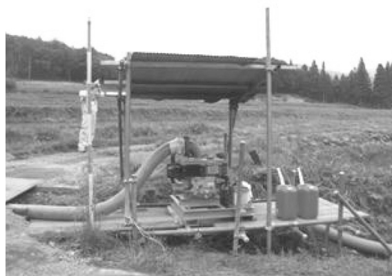
写真IX-15 仮設ポンプによる応急用水手当て(栗原市旧花山村)
