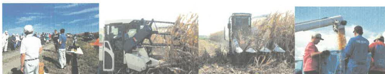
U. M. A. S. I. 代表の概要説明と作業状況 (左：リールヘッダ 中：コーンヘッダ 右：排出)
