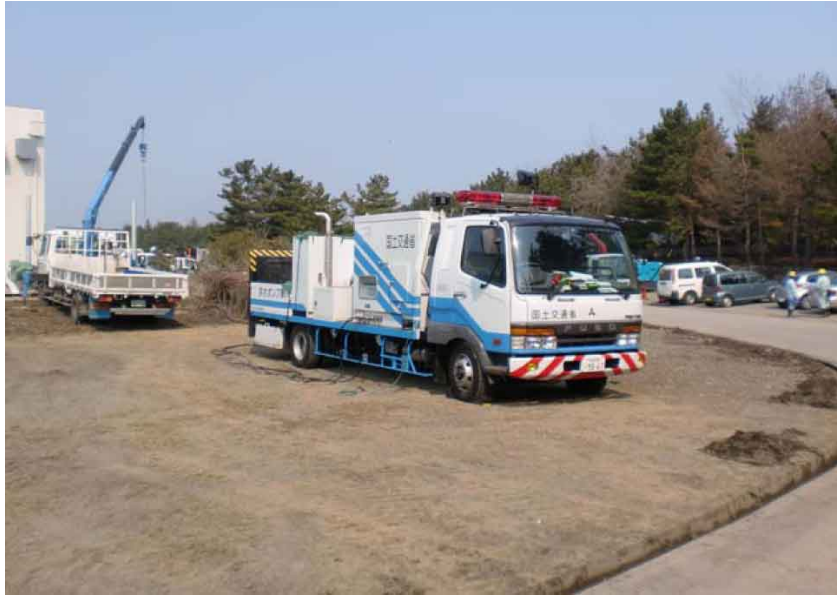
写真 2 - 5 国土交通省排水ポンプ車
