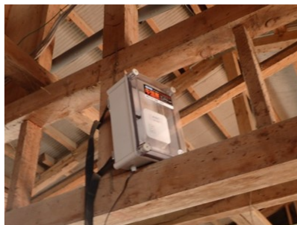
牛舎に取り付けた分娩監視装置受信機
