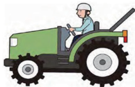
安全フレームを倒したままの移動は危険
