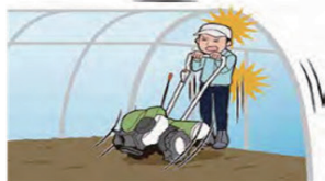
ハウス内で後退時に支柱等に挟まれる危険有り
