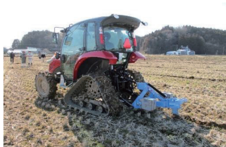
補助暗渠（カットドレーン）施工の様子
