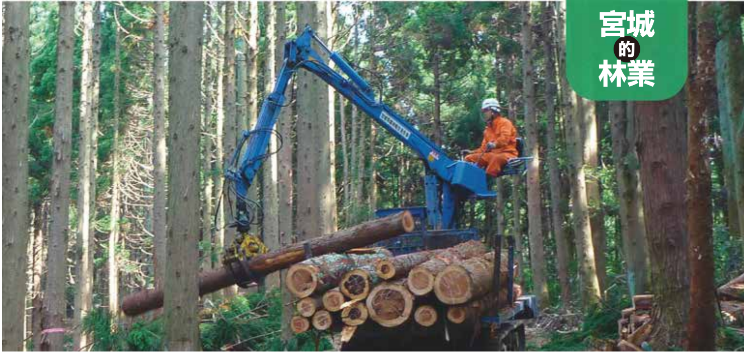
以高性能林業機器集材的作業 (大郷町)
