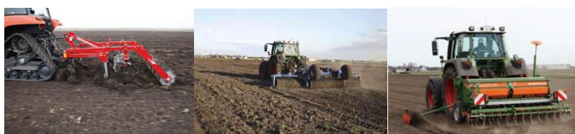
写真 スタブルカルチ（左），ケンブリッジローラ（中），グレーンドリル（右）
