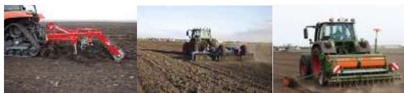
写真 スタブルカルチ(左), ケンブリッジローラ(中), グレンドリル(右)
