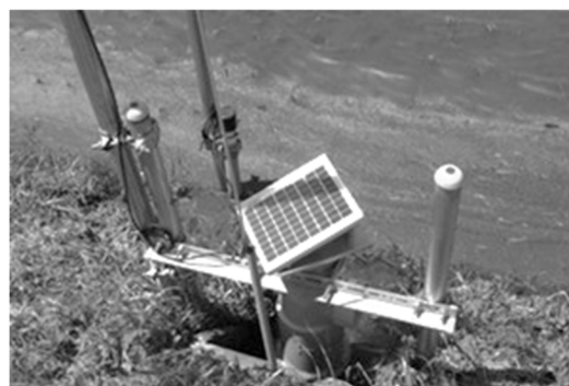
図4 自動給排水システム
