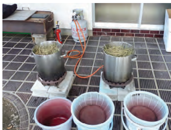
煮出設備 (ガスコンロ2セット)
