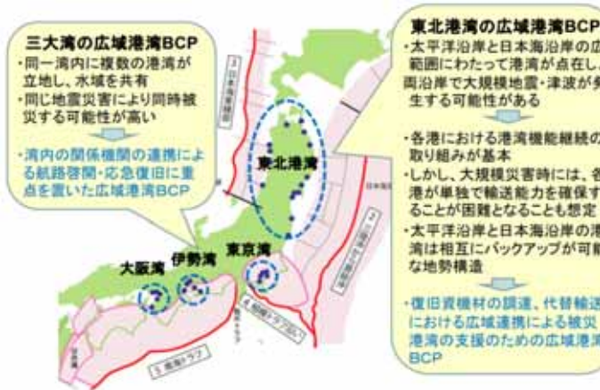
図 1-1 東北港湾と三大湾の広域港湾BCPの違い 出典:東北広域港湾機能継続計画, 東北広域港湾防災対策協議会
