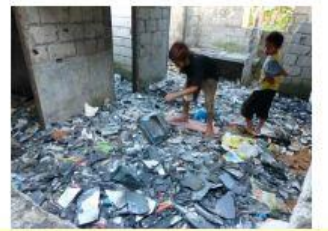
子供が素手とサンダルでCRTの破壊作業 。シャドウマスクと電子銃を回収して、親に渡していた。
