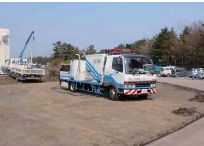
図 3-82 国土交通省排水ポンプ車
