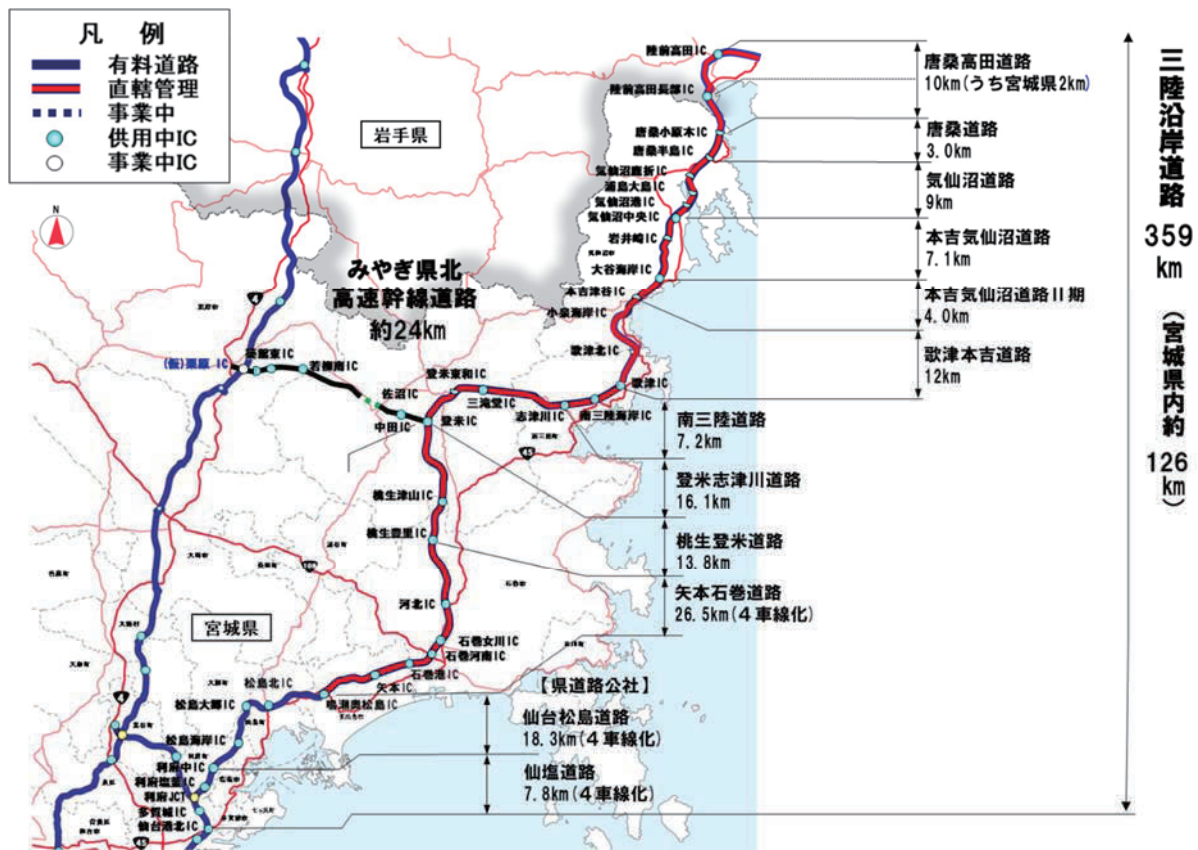
図 3-10 三陸縦貫自動車道
