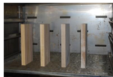
写真-1 100℃急速乾燥試験
