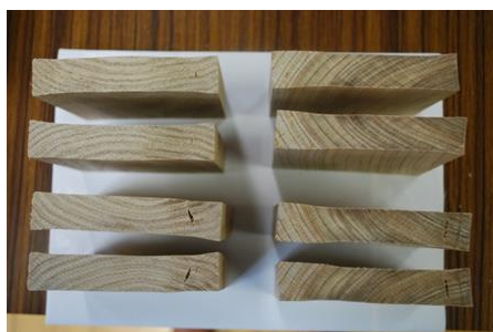
写真-5 損傷等の発生状況 (材中央部断面) 左:ケヤキ, 右:クリ
