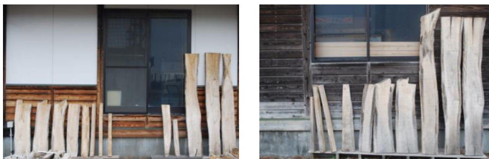
写真-2 天然乾燥試験（左：南向き、右：北向き）
