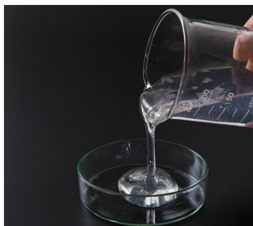
日本製紙の実証生産設備でつくられたセルロースナノファイバー分散液
