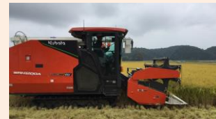
自動運転コンバインによる水稲収穫作業
