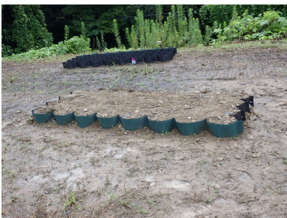
立体ジオセル工法盛土方式モデル
