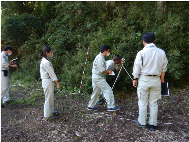
ポケットコンパスを用いた測量実習
