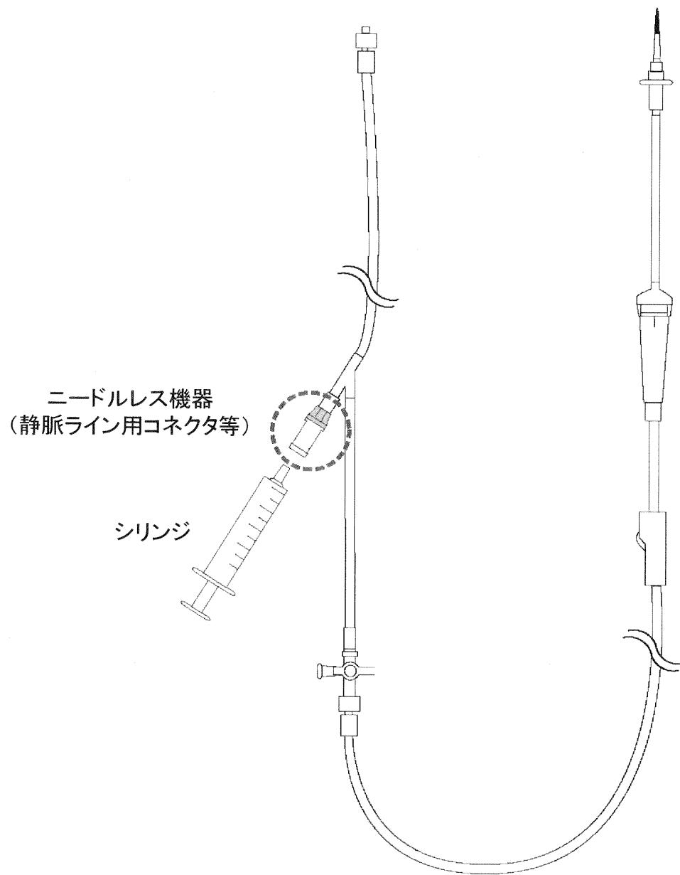
図2. 内部流液管接続型ニードルレス機器
