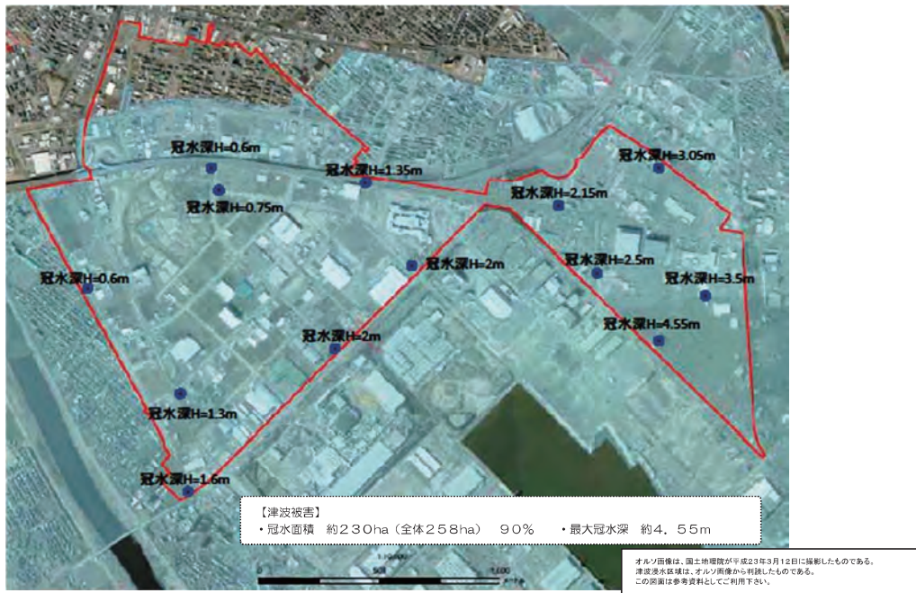
地区内の津波被害による冠水状況
