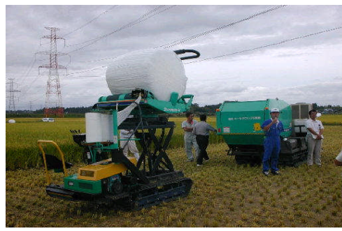
④リフト機能でトラックへの積み込みが可能
