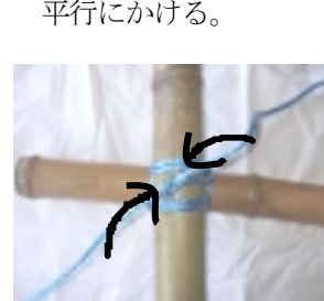
④下の竹の下方からロープを通し上の竹に平行にかける。
