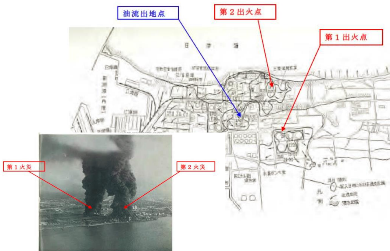
図 2.7.3 新潟地震(1964年)での製油所での出火・延焼状況2
