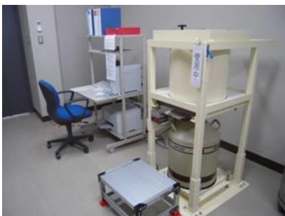
県水産技術総合センターに設置されたゲルマニウム半導体検出器(精密検査用)
