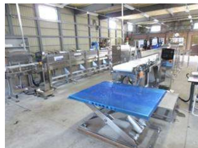
石巻魚市場に設置されている連続個別非破壊放射能測定システム(簡易検査用)
