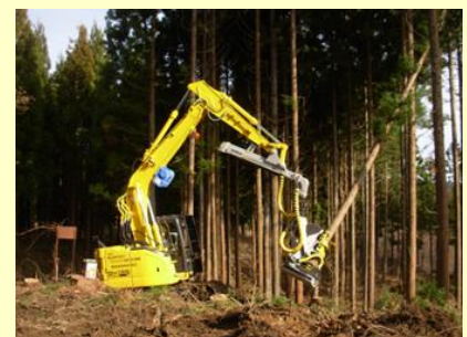
ハーベスタによる伐採作業現場
