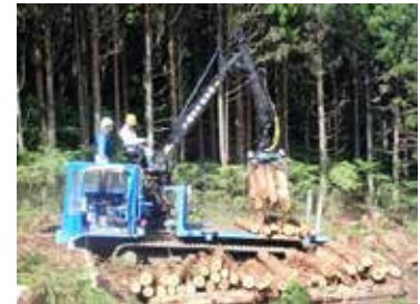
【フォワーダの機械操作】
