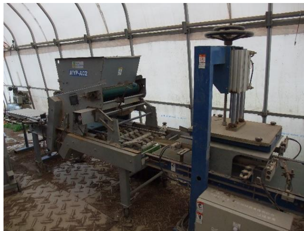
写真4 自動ポットイングマシン
