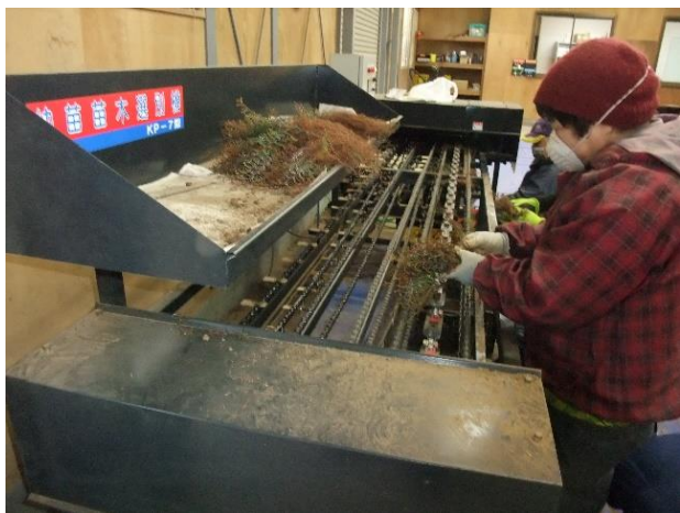
写真3 苗木自動選別機での作業状況
