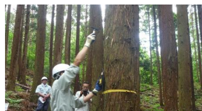
材質調査 (ファコップの上下センサを立木に打ち込み、打撃の到達速度を計測)
