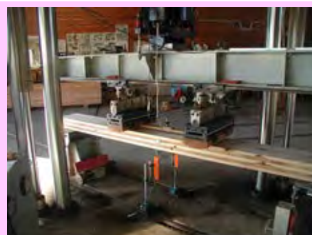
写真1 曲げ破壊試験の様子
