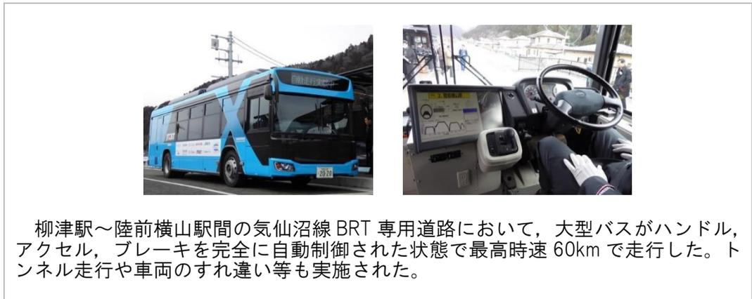
図 4-1-7 自動運転実験走行の様子（令和2年2月 JR気仙沼線BRT陸前横山駅）
