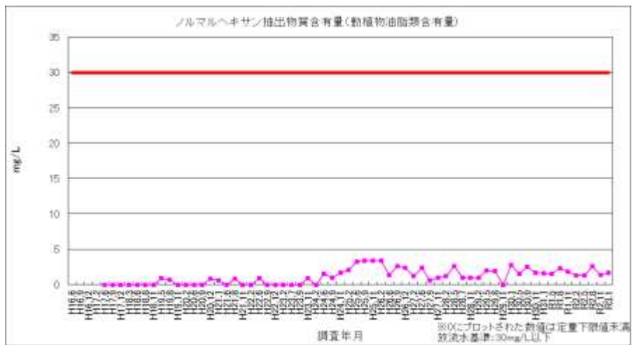
図 2-16 ノルマルヘキサン抽出物質含有量（動植物油脂類含有量）（放流水）
