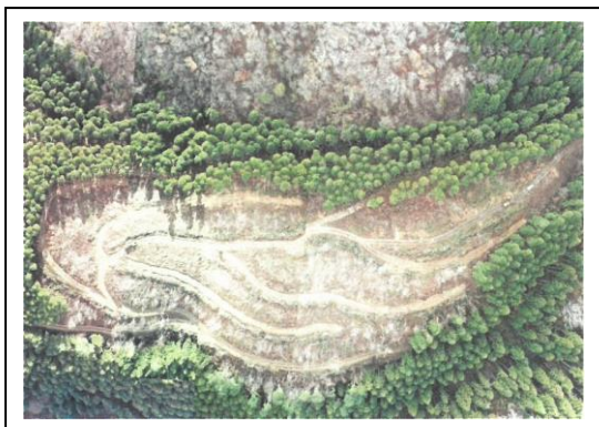
等高線上に作業道作設
