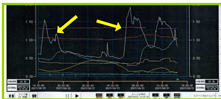
6/20～6/21の二硫化炭素流入時の吐出槽 UV 上昇トレンド
