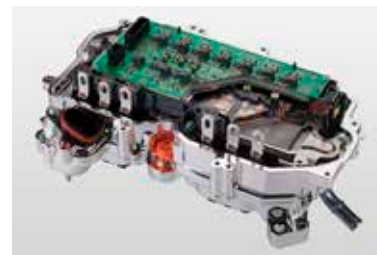
パワーコントロールユニット
