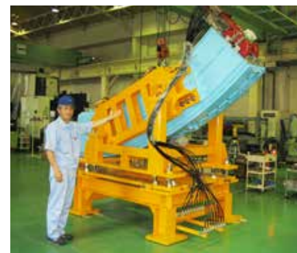
医療施設の加速器に使われている電磁石
