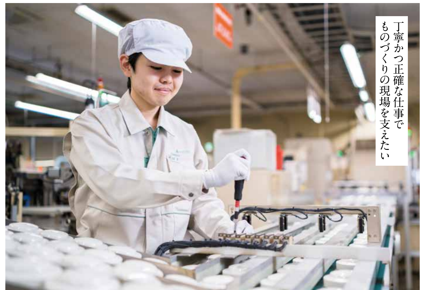
熱感知器の自動生産ラインに取り付けられたセンサーの調整を行う佐藤潤一さん
