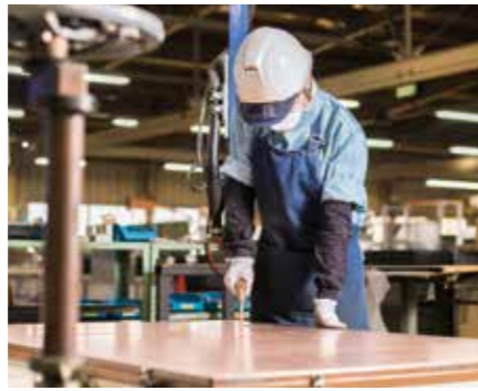
抵抗スポット溶接。材料を加圧した状態で数千〜数万アンペアの大電流を流して溶接する
