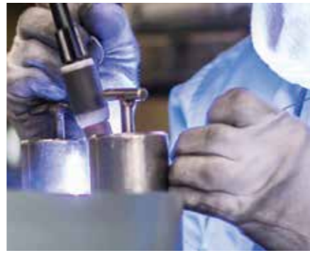
電気溶接の一種TIG溶接。火花が飛び散らず音が静かなため、よく使われる溶接技法である
