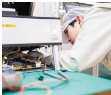
検査機器の内部にある配線や電子基板にキズなどがないか確認する
