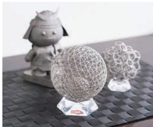
3Dプリンタによる金属積層造型技術で作られた製品。3次元データがあれば複雑な形状でも直接造型が可能だ
