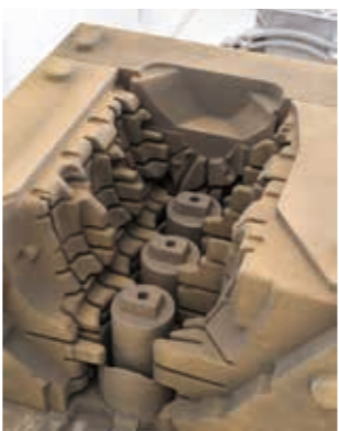
3Dプリンタで作られたエンジンブロックの砂型。複雑な造型が木型なしで再現できるようになった
