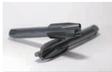
通り穴ネジ加工向きで、切りくずをタップ進行方向に排出。同社の「スパイラルポイントタップ」は、独自開発した2種類の刃を搭載し高寿命・高効率を発揮する
