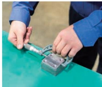
加工が終わった製品の寸法を確認。指示通りに加工してきたかチェックする
