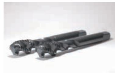
止まり穴ネジ加工向きで、切りくずをタップ進行方向とは逆に排出。同社の「Tシリーズスパイラルタップ」は、2種類の刃によって安定した加工を実現する
