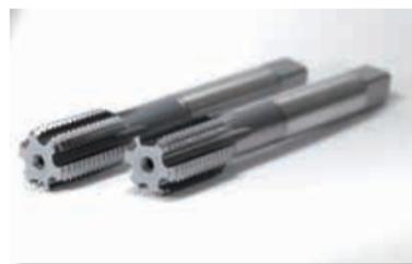
塑性でネジ山を盛り上げて加工し、切りくずを出さないのが特長。同社の「シームレスフレット」は、下穴の寸法にばらつきがあっても、一定の内径のネジ加工が可能
