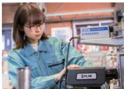
溶けた金属の温度分布を測定する高速度サーモグラフィを設定する
