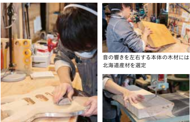
音の響きを左右する本体の木材には北海道産材を選定 職人が一つ一つ丁寧にギター製作に打ち込む やすり掛けをして仕上げた本体には、ネックや弦などのパーツが取り付けられる
