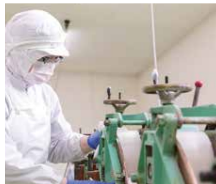
庄延機に着いた粉や生地をきれいに取り除く。機械の掃除や手入れも職人の大切な仕事だ
