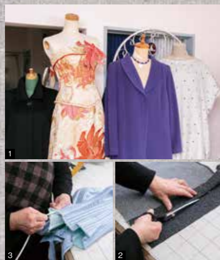
1.仕立てが終わり、持ち主の来店を待つ洋服 2. 裁ちばさみは紳士服を作っていた頃から使い慣れた大きめのものを愛用している 3. ビスチェドレスにボーンを通して形を整えていく。本来ボーンは、数本入れるのが主流だという
