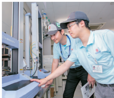
性能試験の様子。製品の材料に使うゴム生地 hardness、弾力などを測定する製品の品質チェックも試験室で行われる
