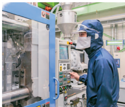
成形機のモニターを確認する。表示されているパラメーターから、金型内部の樹脂の状態を見極める
