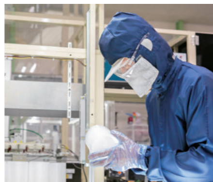
製品を箱詰めする直前に、最終チェックを行う。中に不良品が混じっていないか、一つ一つ目で確かめる
