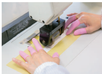
慣れた手つきで、マイクロファイバ製の不織布に折り目と切れ目をつけていく
