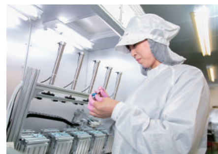
袋詰めされる直前の製品を抽出し、光ファイバのコネクタを使って、品質を確認する
