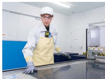
製品の品質を分析するため、任意に抽出した製品を分析器に合うサイズにカットする。不良品を出さないために、分析作業は大切な業務の一つだ
