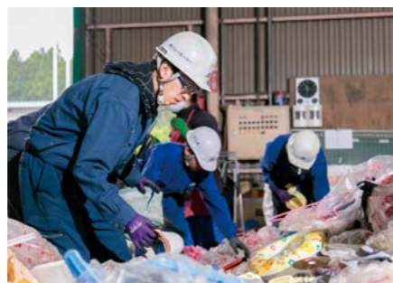
廃プラスチックは手作業で選別。硬さや材質などができる限り細かく分別することで、質の高いリサイクルが実現できるという
