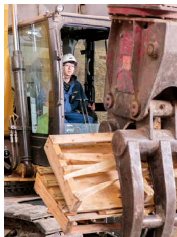
重機を用いて建築現場や解体現場から排出された木材を破碎。太田さんの活躍が光る現場だ
