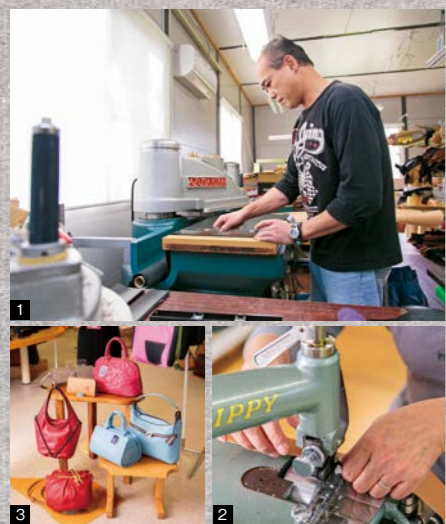
1. 牛革をプレス機で押し抜きする。金型は、パーツごとに違うため、工場には1000パターンを超える型がある 2. 持ち手に使う革を、厚さ1mmから0.3mmまですいていく。薄くすることで皮が折り返しやすくなる 3. デザインと機能性にこだわるフェザントのハンドバッグ。地元の熟練職人の手によって作られている
