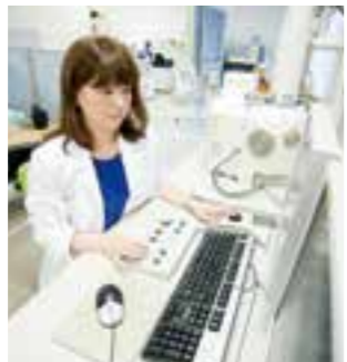
電子顕微鏡でCNTの形状を確認する。不具合が見つかった場合は、次回の製造時にフィードバックして精度を上げていく
